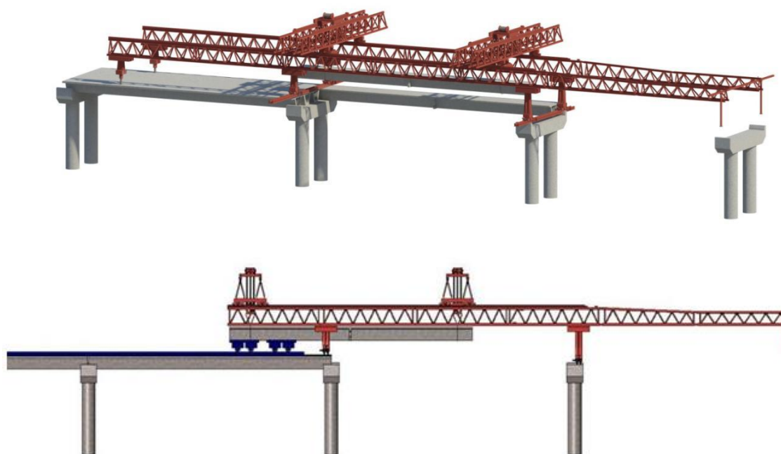
图 3.4-4 260t 架桥机拼装现场图
